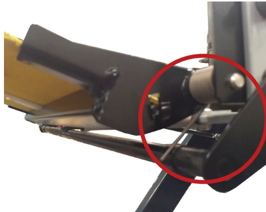
FIGURE 2-9. UNHOOK BRIDGEPLATE SPRING
