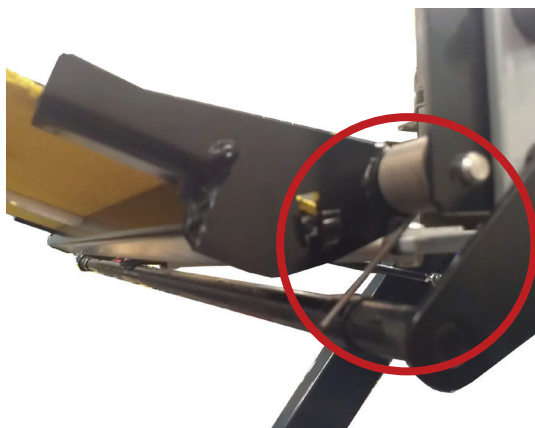
FIGURE 2-9. UNHOOK BRIDGEPLATE SPRING
